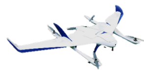
図3 クアッドプレーン型 VTOL UAV (2020年エアロセンス開発、翼長 2.1m)
