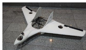
図2 ティルトロータ型 VTOL UAV (2020年開発、翼長 1.9m)
