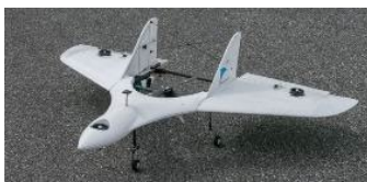
図1 ティルトロータ型 VTOL UAV (2015年開発、翼長 2.2m)
